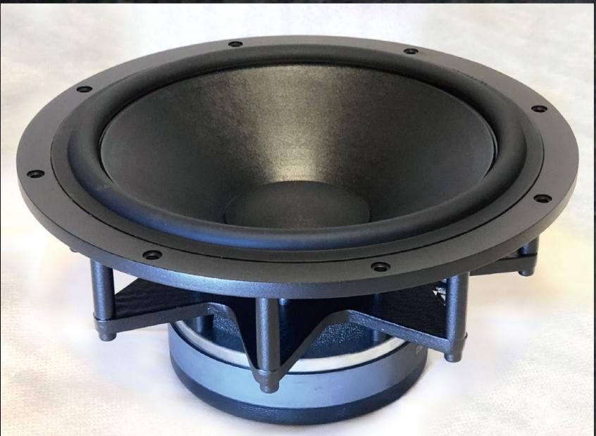
ユニット性能を100%引き出すために、ツイーター・ミッドレンジ後方には、単体金属の中で最強の制振性能を誇る純マグネシウムの巨大なデッドマスを装備、更に20kg以上のヘッド部と強固に連結した上で、ウーファー筐体とは制振ダンパーでアイソレーション。ウーファーには、エンクロージャーとの接点に高質量の真鍮マウントリングを埋め込み不要振動を徹底排除しました。
