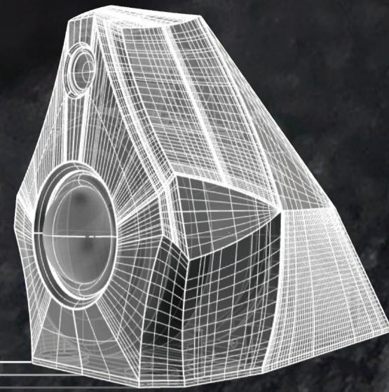
「人の声・楽器の生々しさ」を最重要視した結果、ドライバーユニットは超強力磁気回路 75mm ソフトドームミッドレンジを軸に、高域にはリアルで広大な音場再現が出来る 30mm ダイヤモンドツイーターを低域には最大振幅 47mm を誇る特注仕様の 30cm カーボンサンドイッチウーファーを採用しました。
