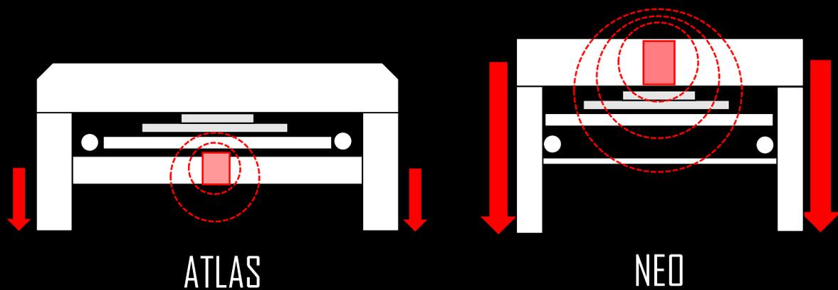
モーターを低いポジションに配置することで、慣性モーメントによる振動の増幅を極力低減させ、メカカルアースを最適化。振動を大幅に低減しました。
