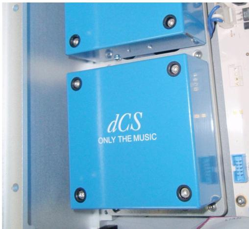
メイントランスは重量級です。機械的振動の発生源ですから、敏感な電子部品から完全に独立されるように、特別に緩衝されたサブシャーシにマウントされています。
