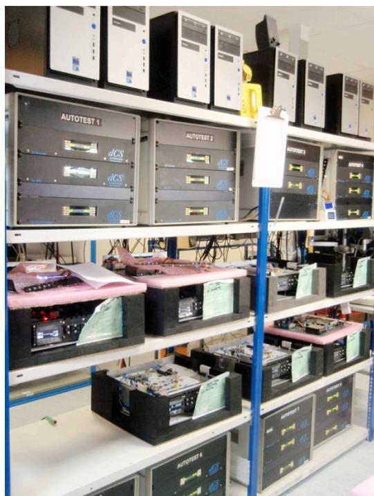
自動テスト装置は dCS が軍需システムを開発した時に誕生しました。各ユニットはここで過酷な試験に耐えねば出荷されません。dCS コンバーターテスト技術はすべて社内で設計、製造され、維持されています。そのためには市販されている最高度の測定装置の計測性能を超えるテスト装置が必要でした。dCS の自動検査装置によって、ソフト、ハード、スペック性能が満たされるべく、過酷な条件で、一台一台、検査が行われます。
