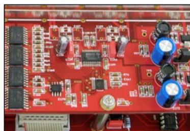
D/Aコンバーター および I/V変換回路
