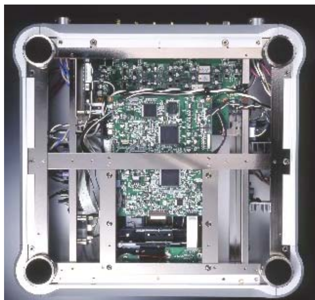
写真 14 P-01 の底部に見えるボトムフレーム
