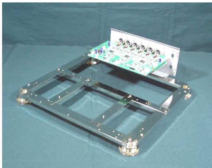
写真 12 リアパネルの取り付け
