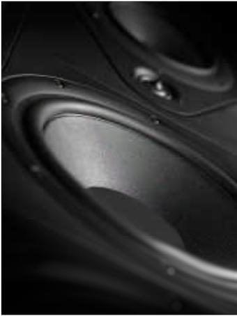
低域ドライバーユニットは **The Sonusfaber** 用として、中域との完璧なつながりと輪郭の明確な低域を実現すべく、二基の 10 インチ口径低域ドライバーユニットを新規設計した。その技術面の革新はハイテク素材のシタクティック・フォームのコアをコーティングされたセルロース・パルプ層で挟むサンドイッチ構造にあり、これによって中域と同様の音色を獲得。カプトン・フォーマーを使用した 3 インチ・ボイスコイルにより限りなくダイナミックなパフォーマンスと低ヒステリシスを実現している。
