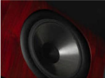
超低域ドライバーユニットは 80Hz 以下という超低域の再現のために、15 インチ口径という大型のドライバーユニットが選定された。このユニットもまたサンドイッチ構造の堅牢な造りになっているが、シタクティック・フォームのコア表面はナノカーボン・ファイバー処理となっている。4 インチ・ボイスコイルは効果的なダンピングのために最適化されている一方、カプトンや航空機用金属をフォーマーに使用、ピストンモーションに伴うロレンツ電流を制御して引き締まった低減再現性を獲得している。また、ローエンドのパフォーマンスをさまざまな部屋の条件に合わせられるよう音圧レベルを調整可能とした。
