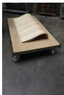
The Sonusfaber に導入された二つの湾曲面を持つ形状「竖琴型」は従来の「リュート型」の進化形です。この湾曲面には、逆目で重ね合わせた積層板材をさらに二層として振動をダンピングする構造となっており、湾曲面が単一の設計に比べて、色付けが低減される点で顕著な優位性を備えています。これを実現するだけでも工業的な設備投資の大きさは言うまでもありませんでした。
