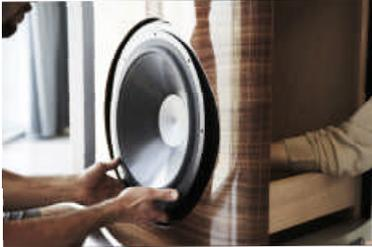
380mm サブウーファーを取り付ける前の工程で、このような手順によってセットされるのが“Anima legata” system なのである。電気的には 3.5 ウェイというクロスオーバーネットワークによって帯域分割された合計 7 基のスピーカーユニットが発生する重厚かつ繊細な音波、各ドライバーが発生する膨大な低域のエネルギーと微小震動をエンクロージャーにも伝搬してしまう中高
